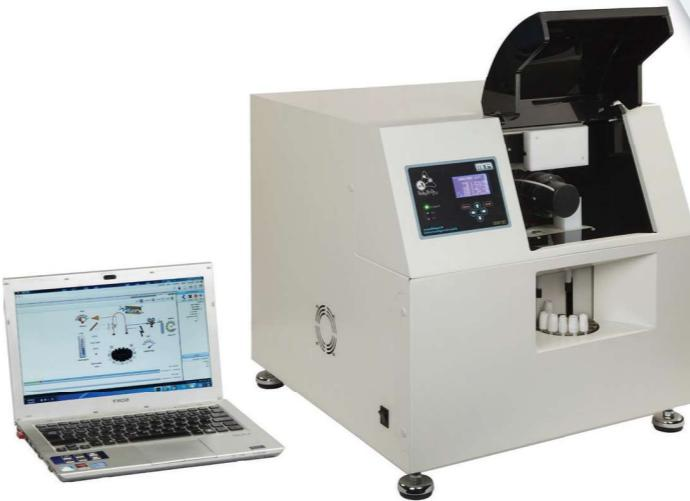
الکتروفورز مویین (CE) یک روش جداسازی و آنالیز است که در این روش مهاجرت اجزای نمونه با سرعتهای مختلف در اثر میدان الکتریکی به کار رفته در یک لوله مویین از جنس سیلیکا که با پلی‌ایمید پوشش داده شده است، صورت می‌گیرد. برای شناسایی اجزای نمونه معمولاً از اسپکترومتر UV یا مرئی از طریق "دربیچه‌ای" در لوله مویین استفاده می‌شود.
